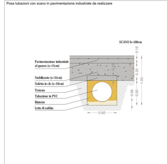
Sezione tipo per scavo posa tubazioni nell'area D (scala 1:20)
