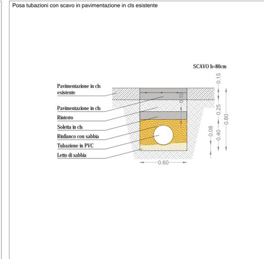
Sezione tipo per scavo posa tubazioni nell'area B (scala 1:20)
