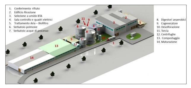
L'impianto tratterà 44.000 tonnellate/anno di rifiuti organici da raccolta differenziata e 7.000 t/anno di rifiuti da sfalci e potature ed andrà a sostituire l'attuale impianto aerobico di compostaggio da 21.000 t/a del complesso Geofor ubicato in località Gello nel comune di Pontedera, Provincia di Pisa; e tratterà le seguenti categorie di rifiuti:
